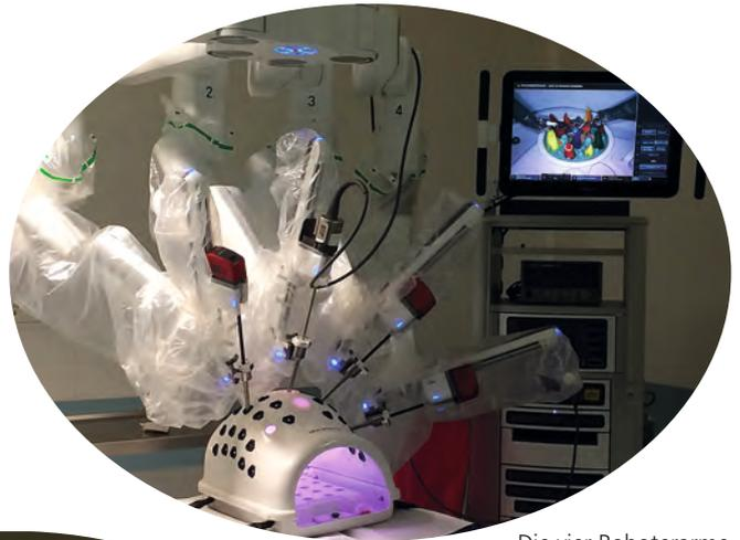
Die vier Roboterarme im Bauchraum-Dummy auf dem OP-Tisch
